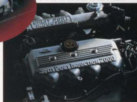
À gauche : Zetec 16 soupapes de la ZX2. Ci-dessous : 2 L de la berline et du break.
