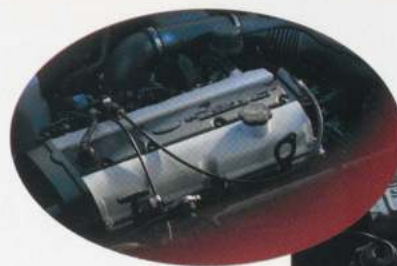
À gauche : Zetec 16 soupapes de la ZX2. Ci-dessous : 2 L de la berline et du break.
