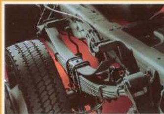
Les amortisseurs service dur et les longs ressorts arrière à lames offrent à la fois le confort de conduite et la capacité de transport de charges. De larges voies avant et arrière améliorent la stabilité.
