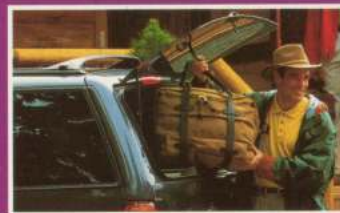
Tous les modèles d'Explorer sont dotés d'un hayon pratique avec glace articulée qui donne l'option d'ouvrir tout le hayon ou seulement la partie supérieure pour faciliter le chargement et le déchargement.
